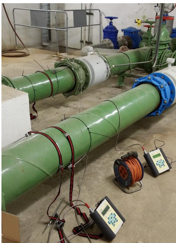
Zapojení průtokoměrů
